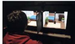
ミニチュアの部屋を用いた実照明下での研究。照明条件により、色や質感の見えがどのように影響を受けるかを調べている。
