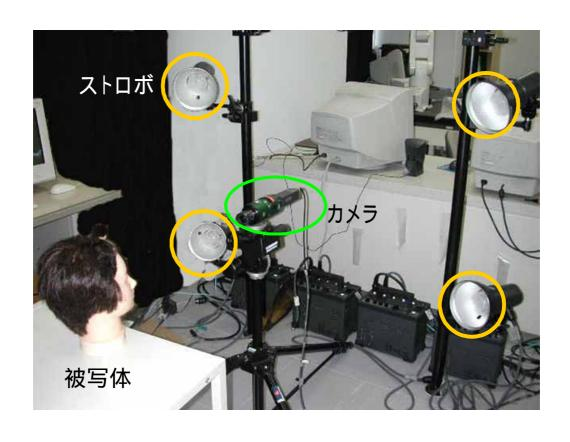
図2 実験で用いた時空間照明変調法による 肌色のモニタリングシステム
