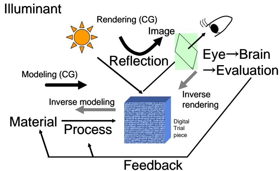
図1 試作品を用いた質感評価の流れ
