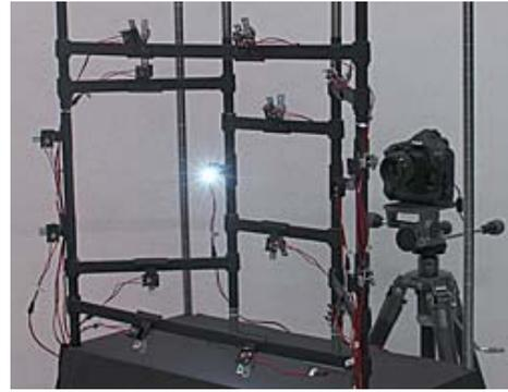
図3 撮影システムのプロトタイプ。デジタル一眼レフカメラと16個の白色LEDランプにより構成。
